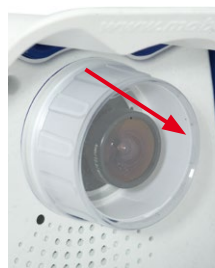
Der weiße Ring in der Objektivkappe verhindert Lichtreflexe durch die Kamera-LEDs
